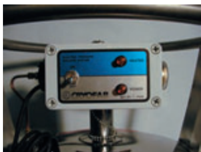
Электрическая система для создания избыточного давления
