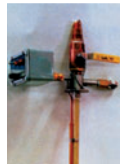
Электрическая система для создания избыточного давления
